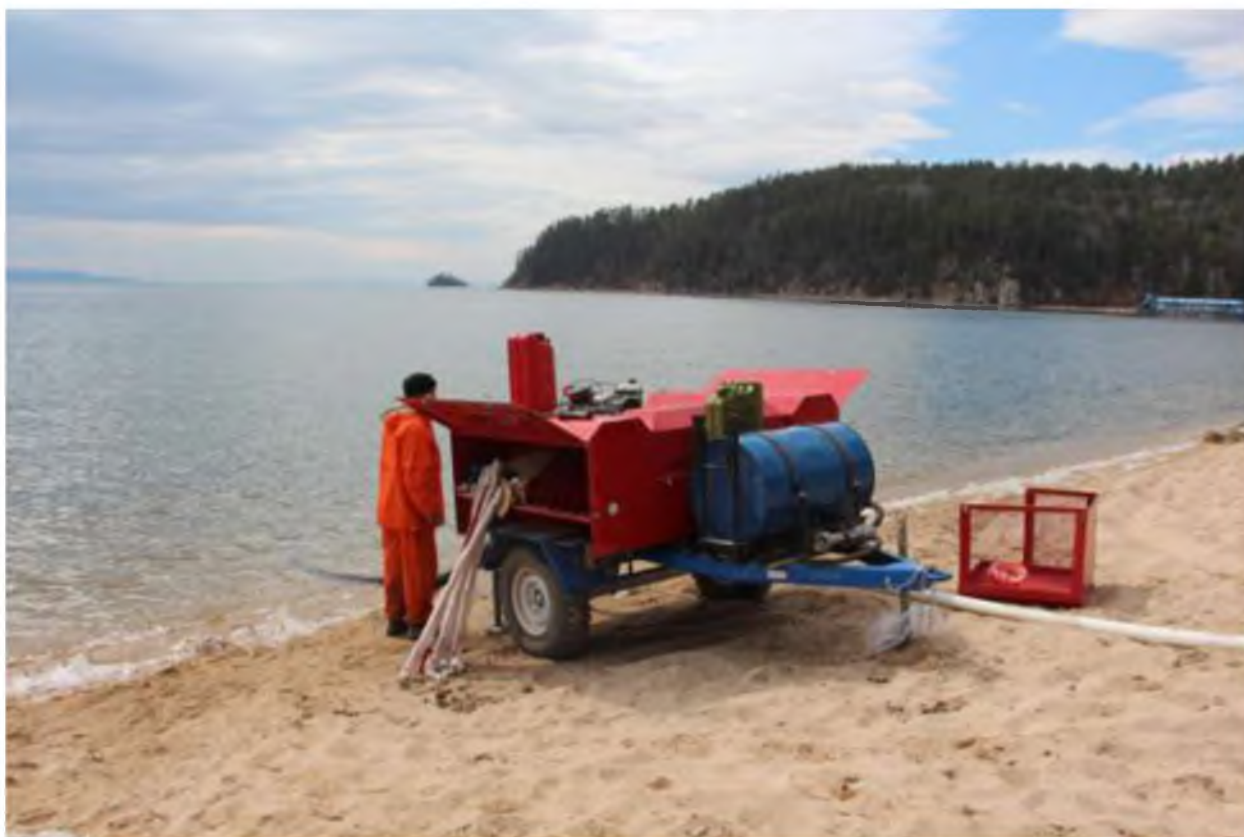
Фото 3. Мобильная мотопомпа большой мощности, применяется при ликвидации пожаров поблизости от водоёма.
